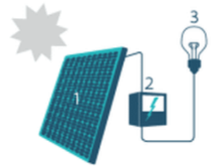
1. Zonnepaneel | 2. Omvormer | 3. Elektrische toestellen
